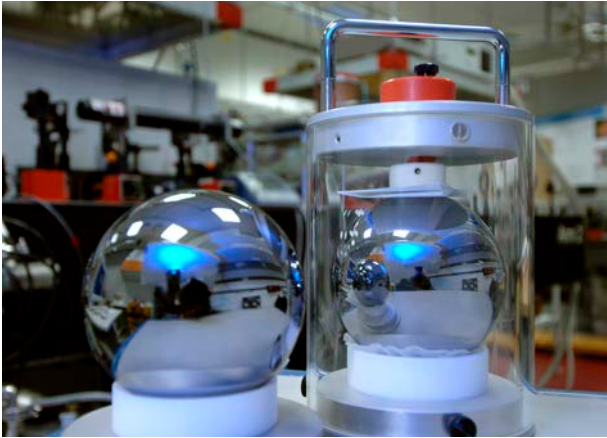
Abbildung 4.F-8 Einkristallkugeln zur Messung der Avogadro-Konstante (Quelle Physikalisch-Technische Bundesanstalt)
