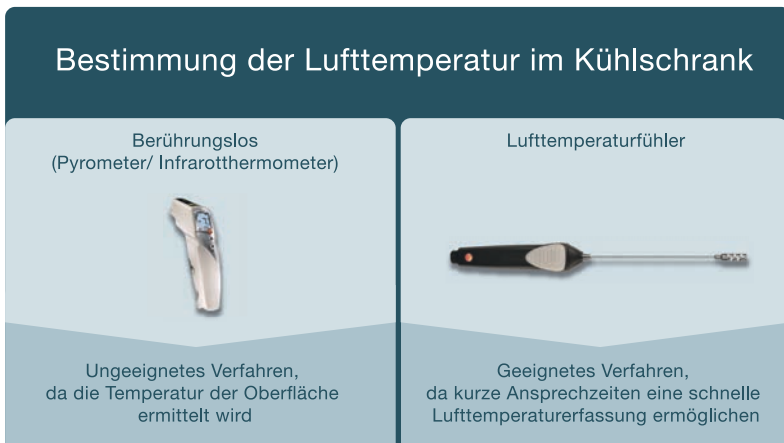
Abbildung 4.F-1 Ermittlung der Lufttemperatur eines Kühlschranks (Abbildung Testo Industrial Services GmbH)
