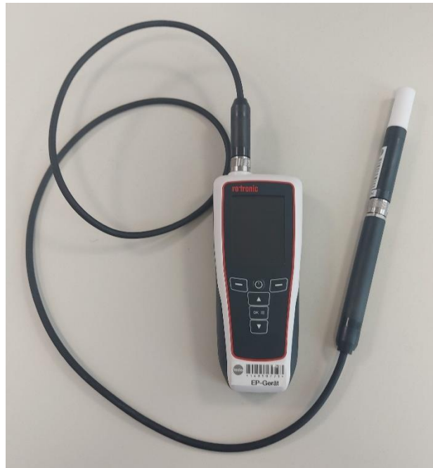
Abbildung 1: Kalibriergegenstand: Feuchtefühler mit Messgerät
